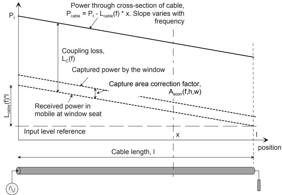
Figure 75 Leaky feeder parameters
